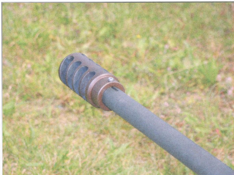
Rys. 4.4. Hamulec wylotowy na lufie karabinu Sako TRG 42
