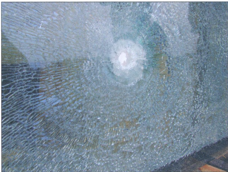
Rys. 6.12. Szyba zespolona stosowana w budynkach wysokich, składająca się z dwóch szyb klejonych o grubości 6 mm każda i szyby hartowanej o grubości 12 mm, przestrzelona pociskiem kal. .338 Lapua Magnum (widok od strony szyby hartowanej)
