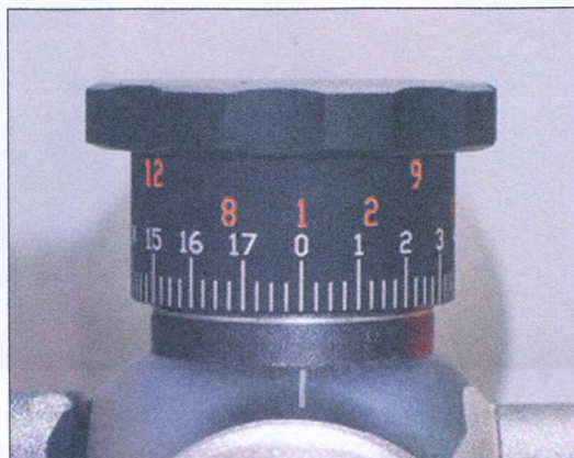
Rys. 3.22. Podziałka BDC (w kolorze czerwonym) na pokrętle regulacji pionowej. Czerwone liczby oznaczają odpowiednio 100, 200, ..., 1200 m, przy czym liczby w górnym rzędzie dotyczą drugiego obrotu pokręta
