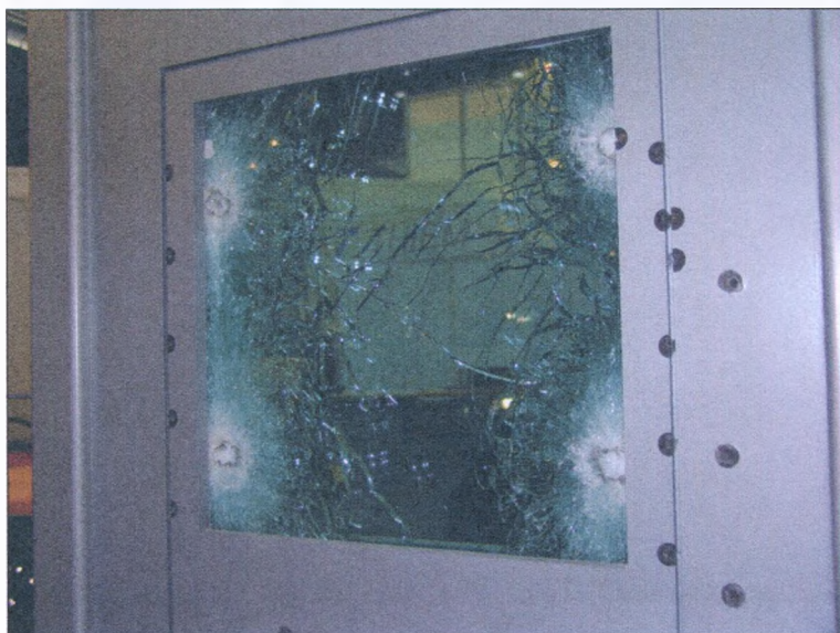
Rys. 6.13. Szyba pancerna klejona, wielowarstwowa, trafiona pociskami kal. .308 Win.
