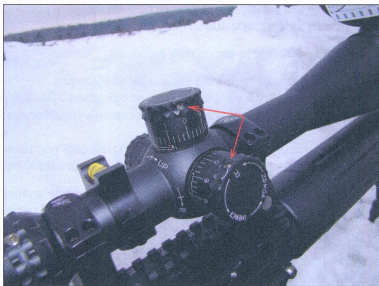
Rys. 7.2. Wkręty ustalające bębny z podziałkami w celowniku Nightforce
