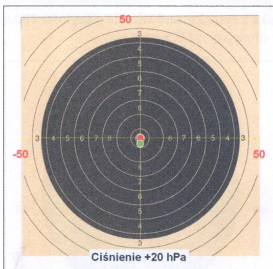
Rys. 9.4. Wpływ błędu w uwzględnieniu zmiany ciśnienia powietrza – celownik wyregulowany dla ciśnienia 997,5 hPa, podczas gdy ciśnienie wynosi 1017,5 hPa (punkt czerwony – odległość 200 m, punkt zielony – odległość 600 m)
