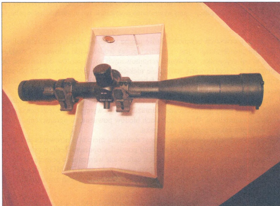
Rys. 3.29. Zaimprovizowane stanowisko do centrowania celownika
