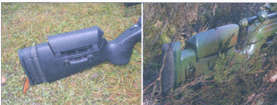
Rys. 3.39. Regulacja baki kolby za pomocą śrub (z lewej) i podkładek (z prawej)
