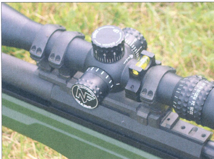
Rys. 3.11. Boczne pokrętko do regulacji paralaksy w celowniku 5,5-22×56 Nightforce
