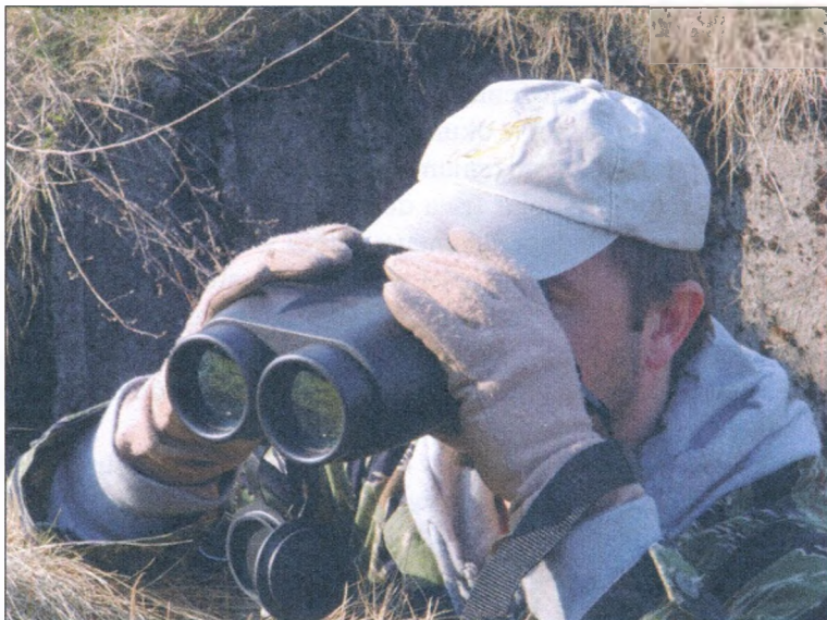
Rys. 7.8. Pomiar odległości za pomocą dalmierza Newcon LRB 4000 CI o zasięgu 4000 m, wyposażonego w kompas, inklinometr i układ do pomiaru prędkości
