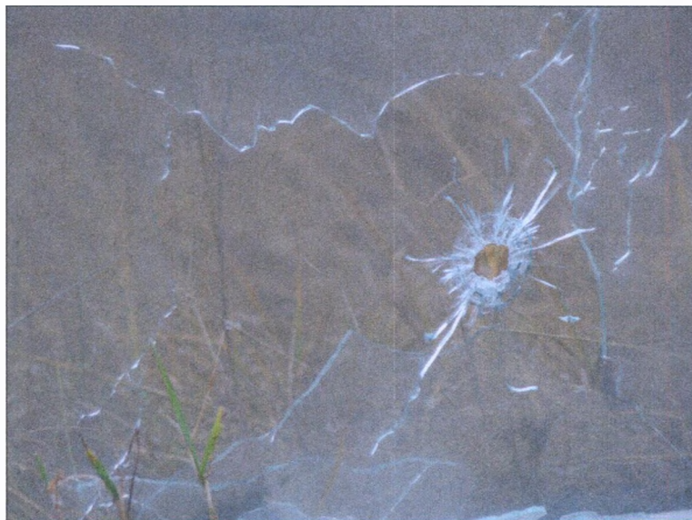
Rys. 6.10. Typowa szyba okienna (zespolona, podwójna) przestrzelona pociskiem kal. .308 Win.
