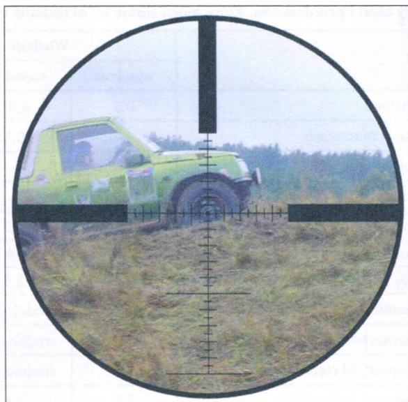
Rys. 3.25. Widok celu na tle siatki z podziałką w tysięcznych. Działki o średniej długości są rozmieszczone co 1 tysięczną, działki najkrótsze wskazują połówki tysięcznej
