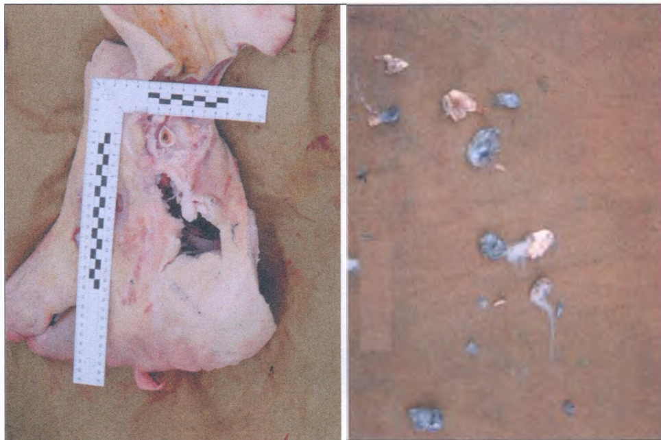
Rys. 6.17. Wynik strzału pociskiem kal. .308 Winchester, Sierra Match King 168 gr przez laminowaną szybę przednią samochodu VW Passat: z lewej strony - świński łeb rażony z odległości 0,5 m od szyby z widocznym, bardzo nieregularnym otworem wlotowym; z prawej strony - fragmenty pocisku wydobyte z przechwytywacza pocisków umieszczonego za łbem
