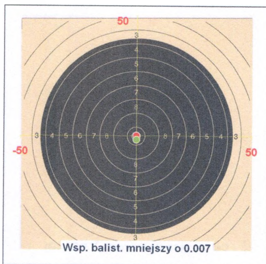
Rys. 9.10. Wpływ różnic we współczynniku balistycznym (punkt czerwony - odległość 200 m, punkt zielony - odległość 600 m)
