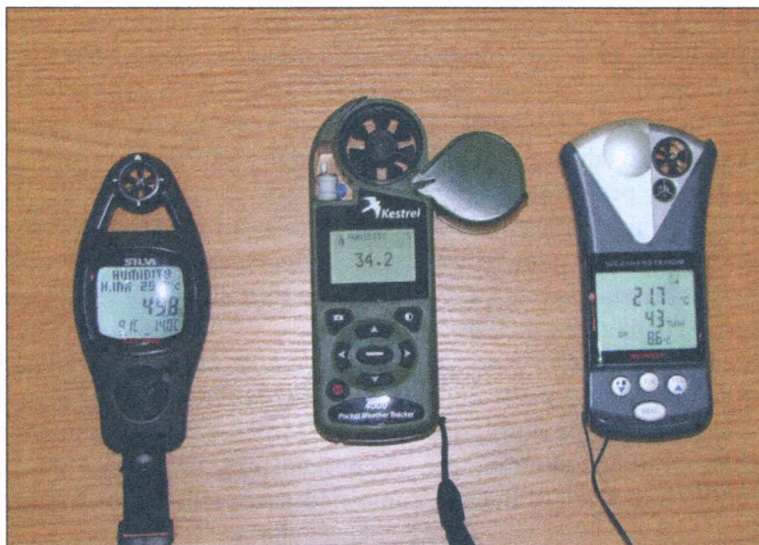
Rys. 7.13. Trzy popularne wiatromierze działające na zasadzie wiatraka (od lewej: SILVA, KESTREL i MINOX)
