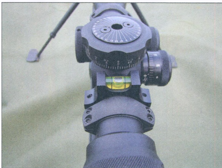
Rys. 5.24. Poziomica stała zainstalowana na celowniku US Optics
