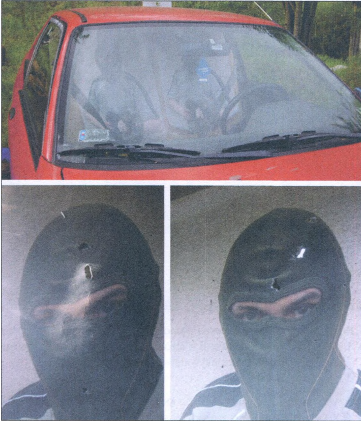
Rys. 6.18. Wyniki ostrzelania tarcz pociskami kal. .308 Winchester przez laminowaną szybę przednią samochodu Ford Escort: z lewej strony – kartonowa sylwetka rażona z odległości 1 m od szyby jednym pociskiem przeciwpancernym Lapua AP; z prawej strony – identyczna sylwetka rażona pociskiem Sierra Match King 168 gr
