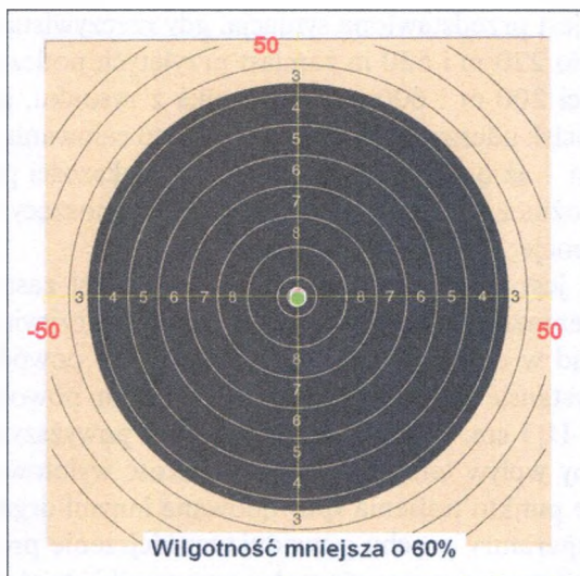
Rys. 9.3. Wpływ błędu w uwzględnieniu wilgotności powietrza – celownik wyregulowany do wilgotności 78%, podczas gdy wilgotność wynosi 18% (punkt czerwony – odległość 200 m, punkt zielony – odległość 600 m)
