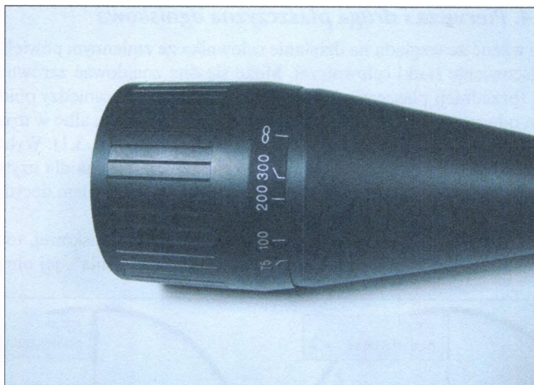
Rys. 3.12. Regulacja paralaksy w obiektywie
