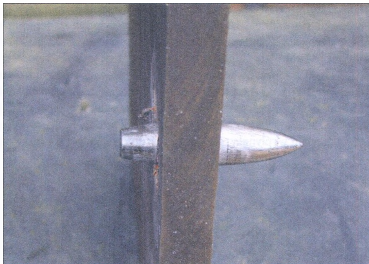
Rys. 6.21. Penetrator pocisku AP kal. .50 BMG uwięziony w płycie pancерnej; na powierzchni płyty widoczne są szczątki płaszczki pocisku (z lewej strony)
