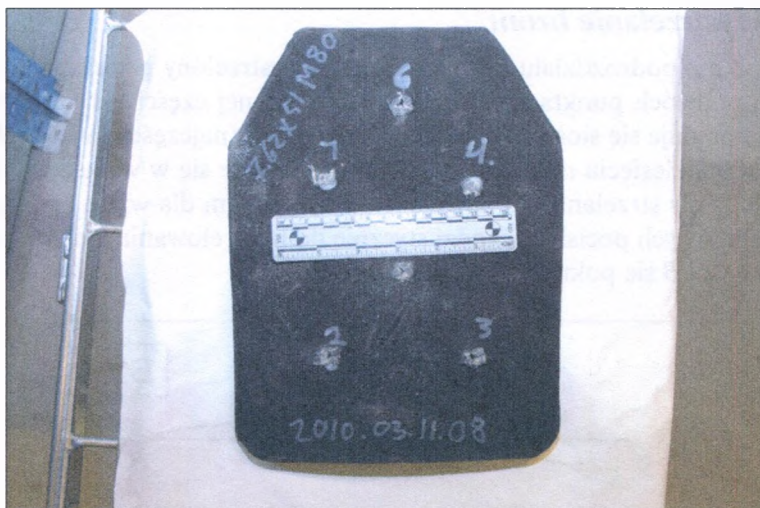
Rys. 6.36. Płyta ceramiczna produkcji NFM (szkło ceramiczne + backing polietylenowy) o poziomie ochrony SK3+ (zgodnie z normą TR2003) testowana łącznie z kamizelką klasy SK1, ostrzelana 6 pociskami kal. 7.62×51 DM111 (M80) o prędkości 830 m/s [zdjęcie pochodzi z materiałów firmy NFM]
