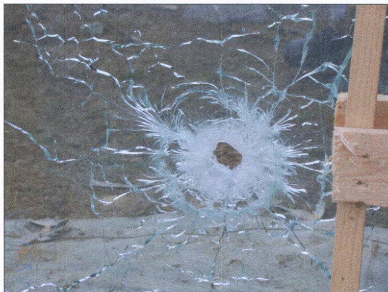
Rys. 6.11. Szyba zespolona stosowana w budynkach wysokich składająca się z dwóch szyb o grubości 3 mm sklejoną folią i szyby zwykłej o grubości 8 mm, przestrzelona pociskiem kal. .338 Lapua Magnum
