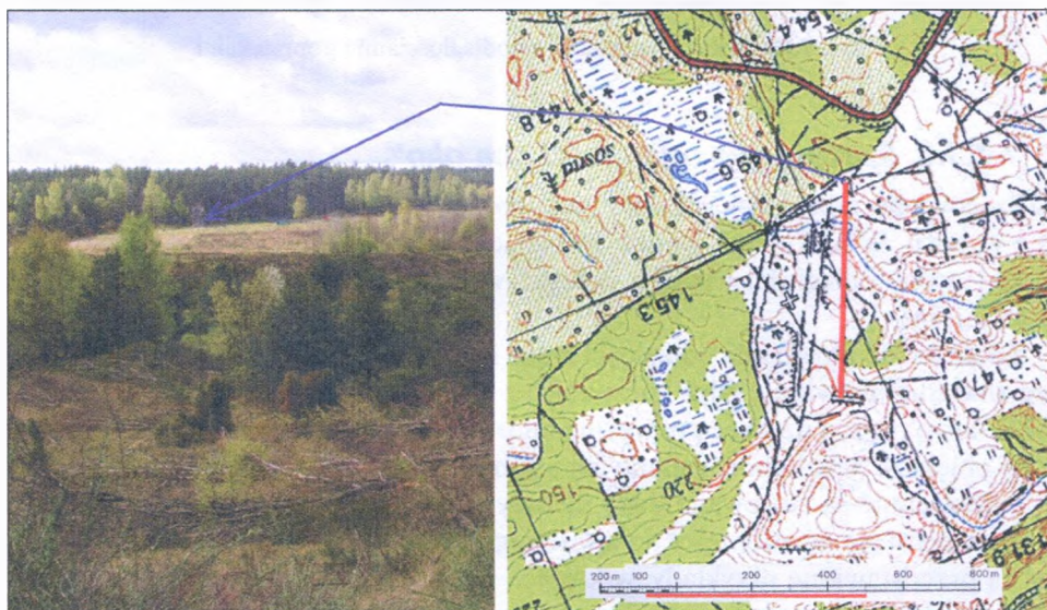
Rys. 7.9. Widok na przedpole i określenie odległości (580 m) od wieży obserwacyjnej za pomocą mapy topograficznej w skali 1:10 000
