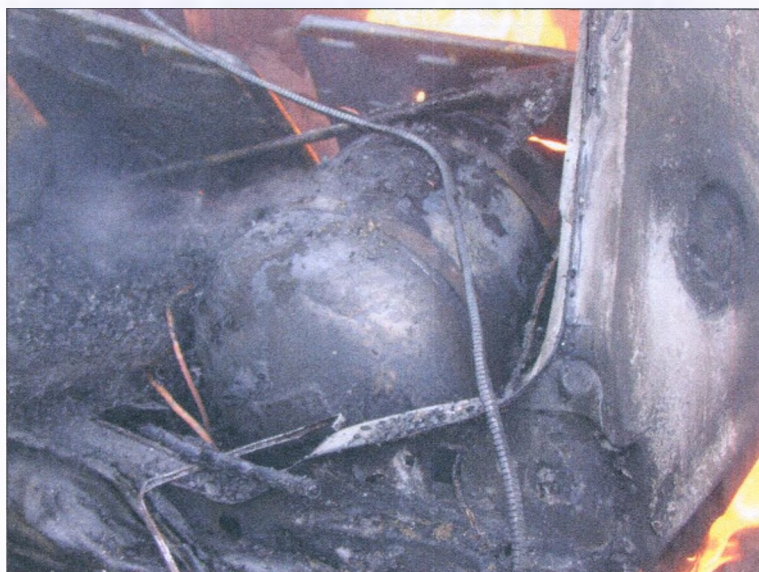
Rys. 6.35. Zbiornik LPG przestrzelony od strony siedzenia, widok w trakcie gaszenia pożaru
