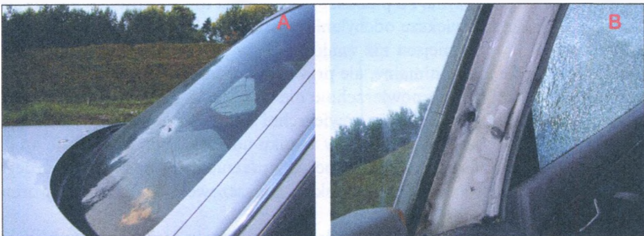
Rys. 6.15. Laminowana szyba samochodu Mercedes przestrzelona pod bardzo niewielkim kątem pociskiem kal. .223 Rem. (SS109 62 gr, rdzeń stalowy): A - widok z kierunku oddania strzału; B - słupek, w który uderzył pocisk po przebiciu szyby
