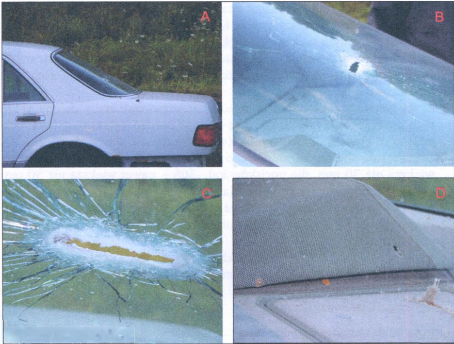
Rys. 6.14. Laminowana szyba samochodu Mercedes przestrzelona pod bardzo niewielkim kątem pociskiem kal. .338 Lapua Magnum (Scenar 250 gr): A - widok z miejsca oddania strzału; B - przestrzelina widziana od zewnątrz; C - przestrzelina widziana od wewnątrz; D - ślady uderzenia odłamków pocisku o tapicerkę wewnątrz pojazdu
