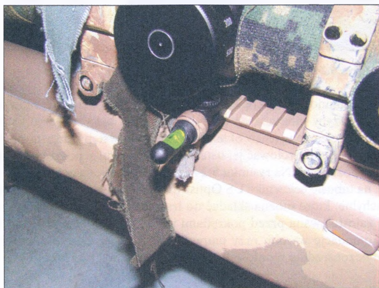
Rys. 5.26. Poziomica montowana do szyny produkcji US Optics
