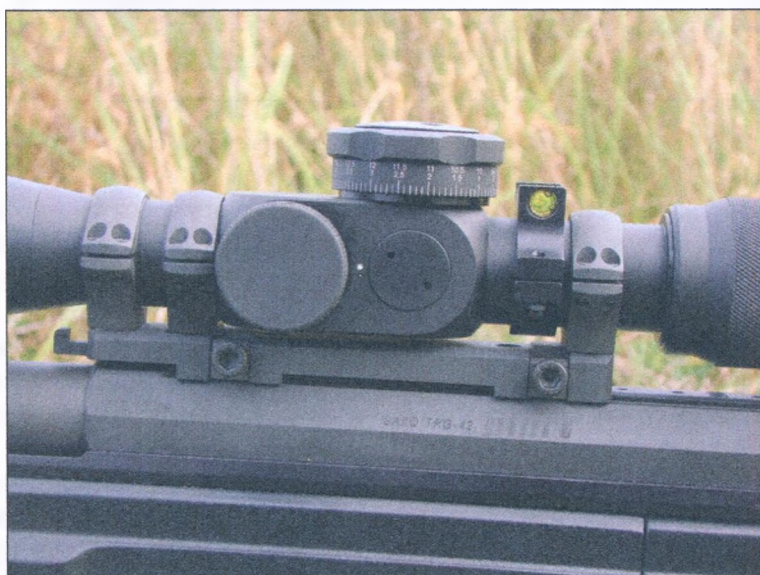
Rys. 3.34. Montaż typu monolitycznego z trzema obejmami (karabin SAKO TRG-42, celownik US Optics)
