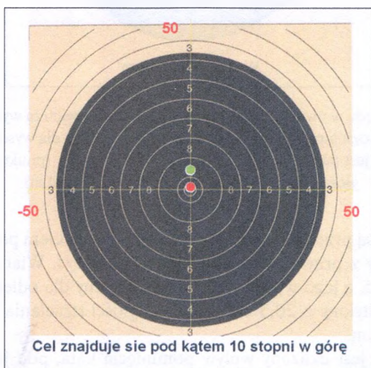
Rys. 9.7. Wpływ nieuwzględnienia kąta o wartości 10^\circ w górę, pod jakim znajduje się cel (punkt czerwony – odległość 200 m, punkt zielony – odległość 600 m)
