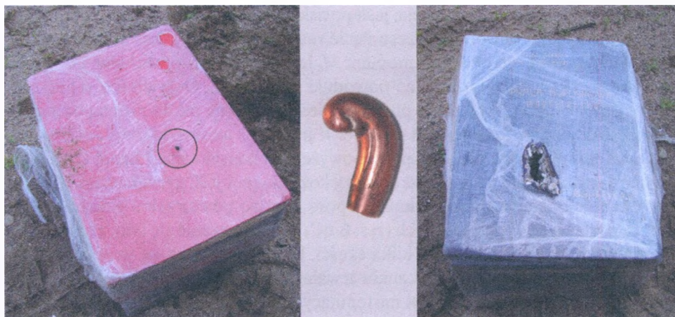
Rys. 6.8. Skutki strzału z odległości 100 m pociskiem monolitycznym kalibru .408 CheyTac do bloku suchego papieru o grubości 20 cm: z lewej – otwór wlotowy; z prawej – otwór wylotowy (pocisk zatrzymał się w kolejnym bloku papieru niemal na jego powierzchni); w środku – wygląd odzyskanego pocisku
