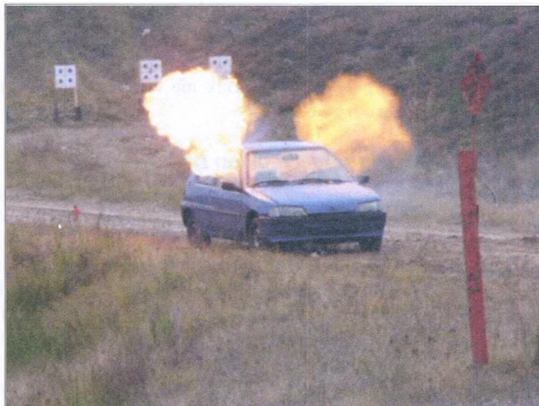
Rys. 6.34. Moment wybuchu gazu wydobywającego się z przestrzelonego zbiornika LPG
