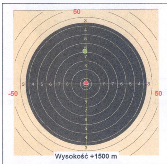
Rys. 9.5. Wpływ błędu w uwzględnieniu zmiany ciśnienia powietrza wynikającej ze zmiany wysokości nad poziomem morza – celownik wyregulowany dla wysokości 0 m n.p.m., podczas gdy strzał jest oddawany na wysokości 1500 m n.p.m. (punkt czerwony – odległość 200 m, punkt zielony – odległość 600 m)
