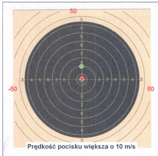
Rys. 9.9. Wpływ prędkości pocisku zwiększonej o 10 \text{ m/s} (punkt czerwony - odległość 200 \text{ m} , punkt zielony - odległość 600 \text{ m} )
