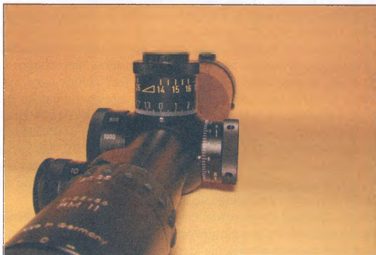
Rys. 3.28. Celownik S&B, w którym po założeniu na montaż pochylony jest wykorzystywany cały zakres regulacji – przy wyzerowaniu na dystansie 100 m pokrętko jest w pełni wkręcone
