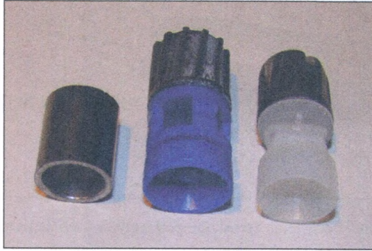
Rys. 5.10. Pociski, których stabilizacja jest uzyskiwana poprzez przesunięcie środka naporu za środek ciężkości
