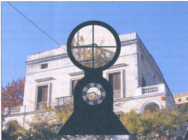
Rys. 3.37. Celowanie przez lufę. Otwór wylotowy lufy powinien być widoczny centrycznie w stosunku do stożka przejściowego w komorze nabojej
