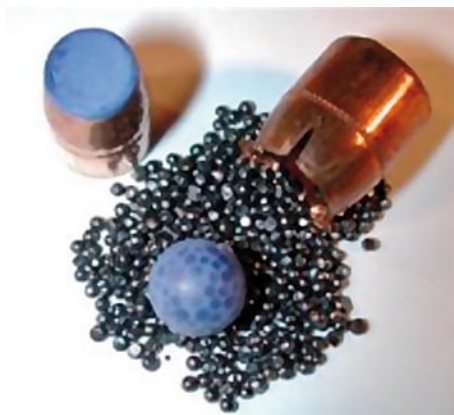
Rys. 57. Pocisk fragmentujący firmy Glaser Safety Slug: w górnym rogu – pocisk kompletny, w środku – pocisk po rozcaleniu [71], dzięki uprzejmości FirearmsID http://www.FirearmsID.com
