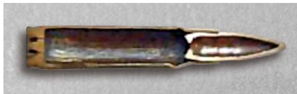
Rys. 36. Budowa naboju 7,62x51 mm [83], dzięki uprzejmości Jordi Camerón Vinaixa, http://www.municion.org
