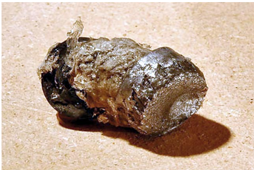
Rys. 4. Zdjęcie pocisku kulowego z naboju Remington Reduced Recoil, wystrzelonego ze strzelby z lufą o długości 356 \cdot 10^{-3} m, po zderzeniu z żelatyną balistyczną 10% [91], dzięki uprzejmości Eclectic Works Company, Calgary Alberta, Kanada
