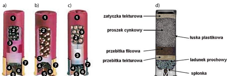
Rys. 58. Schemat budowy naboju śrutowego do strzelb gładkolufowych: ze śrucinami: a) ołowianymi, b) stalowymi, c) ze stopu wolframu z żelazem [70], dzięki uprzejmości Federal Cartridge Company oraz d) naboju proszkowego, dzięki uprzejmości Dynamit Nobel AmmoTec; oznaczenia: 1 – łuska, 2 – śruciny, 3 – przybitka, 4 – ładunek prochowy, 5 – spłonka, 6 – przybitka, 7 – obudowa metalowa łuski, 8 – koszyczek, 9 – proszek amortyzujący zderzenia śrucin
