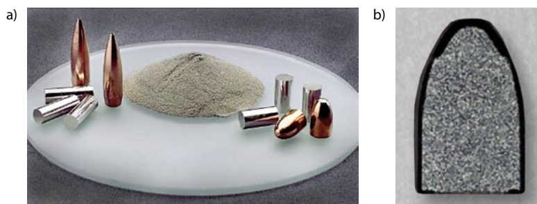
Rys. 56. Pociski fragmentujące: a) wykonane z proszków metali, b) przekrój pocisku [10], dzięki uprzejmości Oak Ridge National Laboratory
