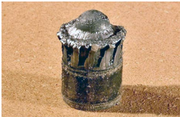
Rys. 70. Zdjęcie pocisku breneki po zderzeniu z żelatyną balistyczną 10% [91], dzięki uprzejmości Eclectic Works Company, Calgary Alberta, Kanada
