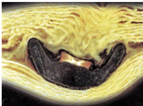
Rys. 72. Pocisk, który uległ tzw. grzybkowaniu podczas penetracji kamizelki, dzięki uprzejmości TEIJIN twaron
