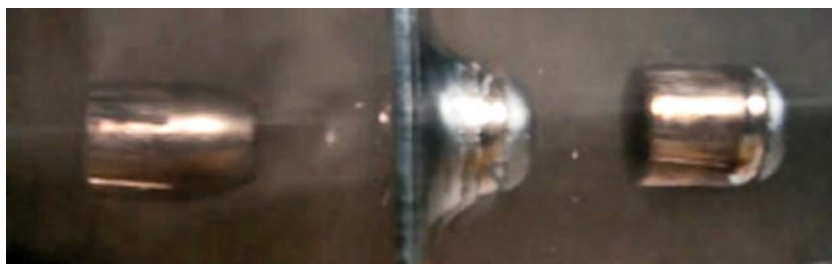
Rys. 21. Zdjęcia pocisków EMB naboju 9x19 mm Parabellum przebijających przeszkodę zbudowaną z płyt stalowych o grubości 1 \cdot 10^{-3} m: a) pocisku przebijającego 6 płyt, b) pocisku po przebicju 6 płyt, c) pocisku w trakcie przebijania płyty [75], dzięki uprzejmości Pana Werner Mehl, Kurzzeitmesstechnik, www.kurzzeit.com
