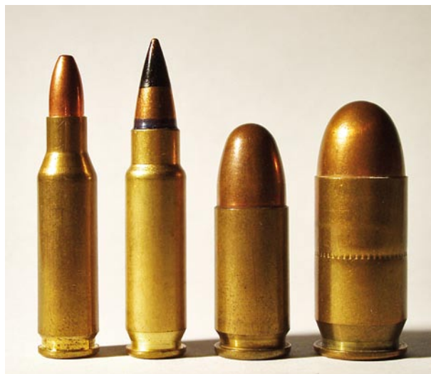
Rys. 25. Zdjęcia nabojev: od lewej; 4,6x30 mm HK, 5,7x28 mm FN, 9x19 mm NATO, .45 ACP [55], dzięki uprzejmości Pana Tony Williams, www.quarry.nildram.co.uk/
