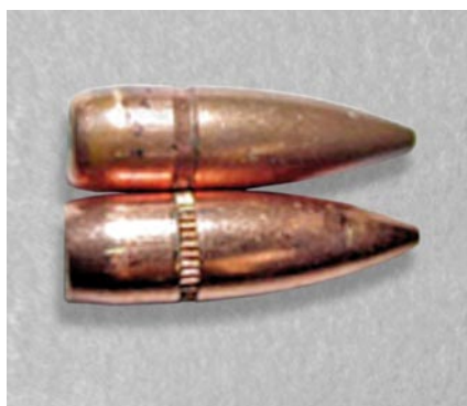
Rys. 42. Pocisk z naboju kalibru 5,56×45 mm M193 wyprodukowany w Lake City – USA – górny (w roku 2000), a w RPA – dolny (w roku 1986) [49], dzięki uprzejmości Ammo Oracle http://www.ammo-oracle.com/body.htm
