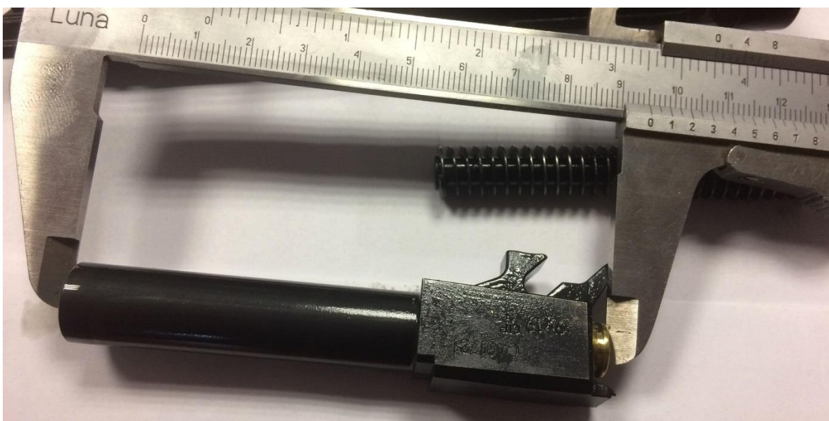
Rysunek 7 - Długość lufy wraz z komorą naboju i wprowadzonym nabojem 9mm PARA – 95mm
